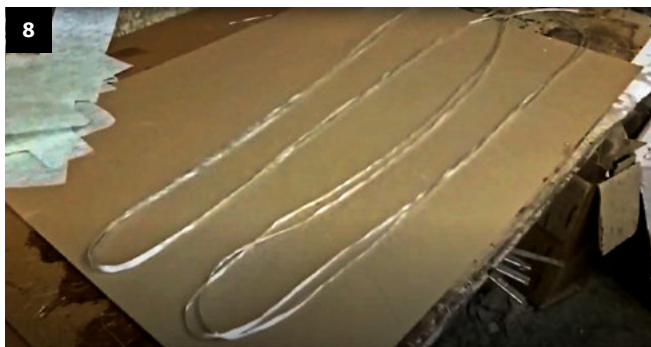
Стеклоровинг для формовки острых углов
