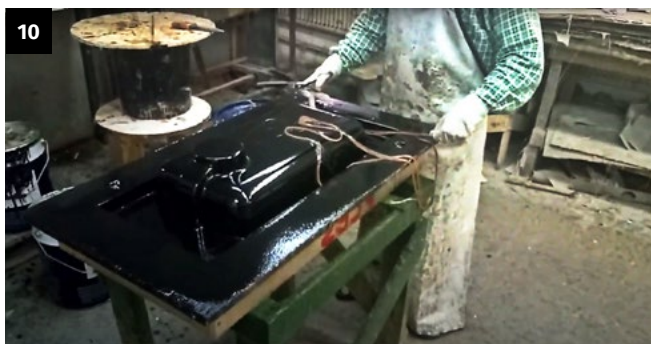
Укладываем ровинг в острый угол
