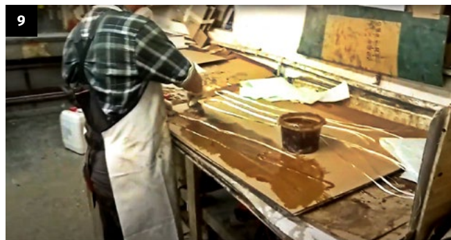
Промачивание жгута стеклоровинга
