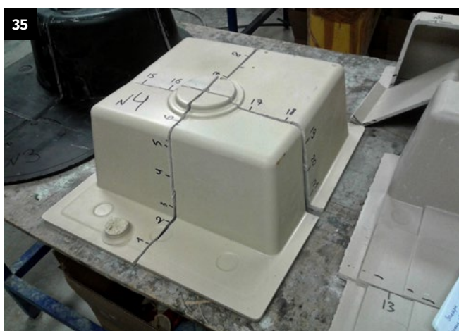
Рисунки 35–36. Способ контроля толщины реального изделия
