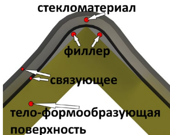
Рисунок 15. Правильная формовка острых выпуклых углов матрицы или изделия
