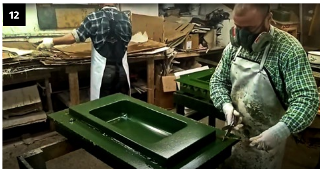
Укладка ровинга в острые углы
