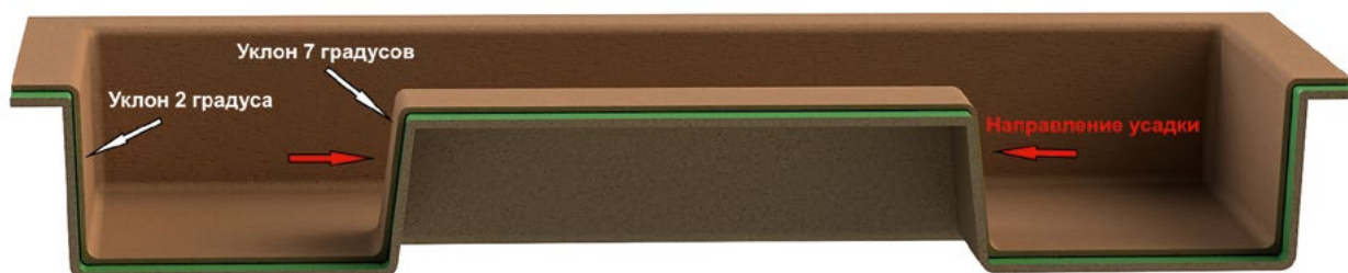
Рисунок 1. Стеклопластиковое изделие, полученное контактном формованием
