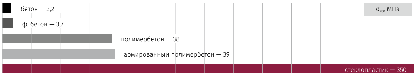
Рисунок 3. Результаты испытаний различных видов материалов на изгиб
