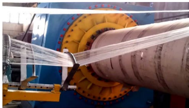
Рисунок 2. Ручное формование и намотка стеклопластиковых изделий
