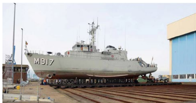
Рисунок 3. Противоминный корабль класса Tripartite на слипе [1]
