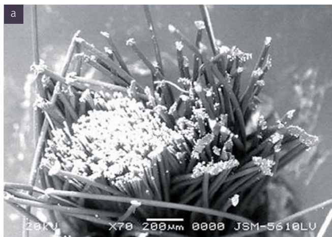
Рисунок 6. а — стеклоровинг, обмотанный полипропиленовым волокном [19]; б — схема совместного вытягивания волокон стекловолокна и термопласта [20]
