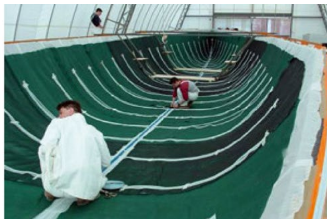
Рисунок 3. Изготовление корпусов яхт из армированной стеклотканью полиэфирной смолы
