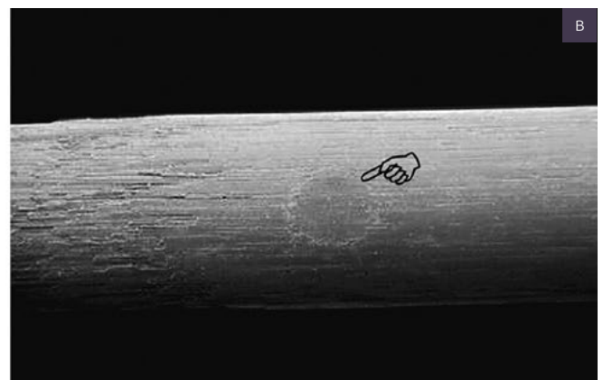
Рисунок 2. а — зависимость предела прочности штифтов на изгиб от диаметра филаментов [4]; штифты после испытаний на циклический изгиб: б — Luscent Anchors; в — DT Light-post [10]
