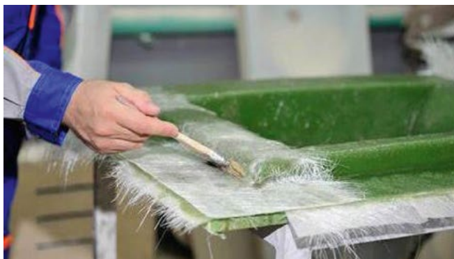
Рисунок 2. Ручное формование и намотка стеклопластиковых изделий
