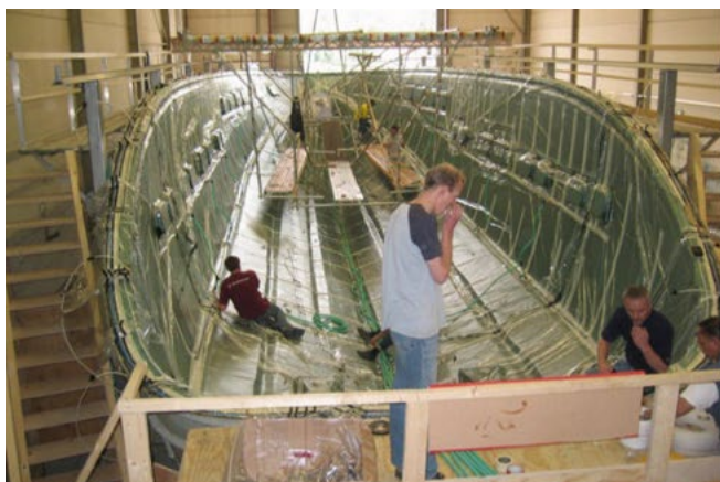
Рисунок 3. Изготовление корпусов яхт из армированной стеклотканью полиэфирной смолы
