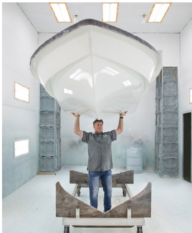
Рисунок 2. Корпус, изготовленный из высокомоульного полипропиленa, углепластика и нетканых материалов
