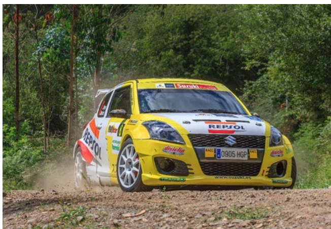
Рисунок 3. Для изготовления бампера и передних крыльев потребовалось два слоя арамидной ткани и один слой стекловолокна
