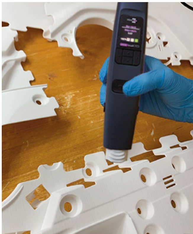
Обработка PA12 перед приклейкой генератором Piezobrush PZ3. Повышение адгезии в 3 раза в сравнении с использованием химических праймеров
