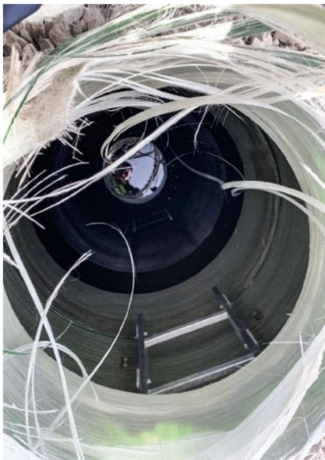
Рисунок 3. Расслоение ламината при нагрузке по причине плохой пропитки армирующих материалов связующим
