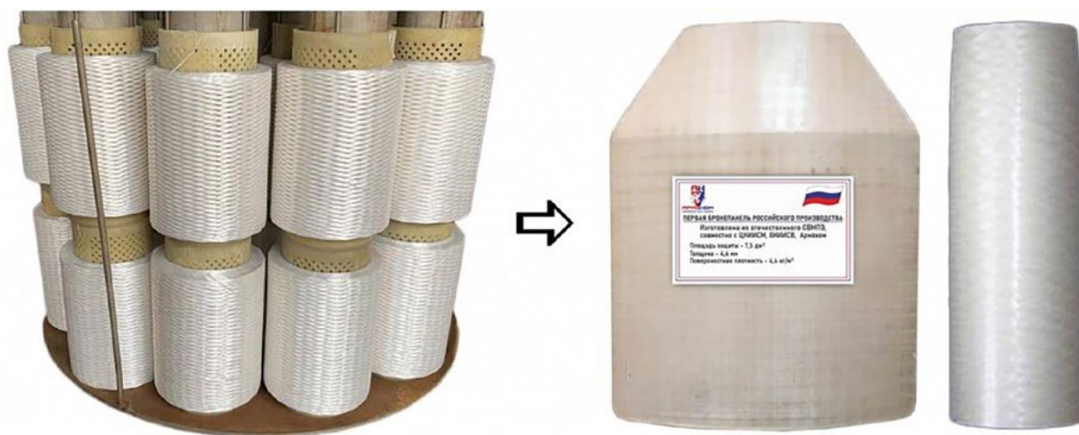
Фото 7. Исходные нити СВМПЭ и панели из СВМПЭ композита — грудная и ножная (Источник: armocom.ru)
