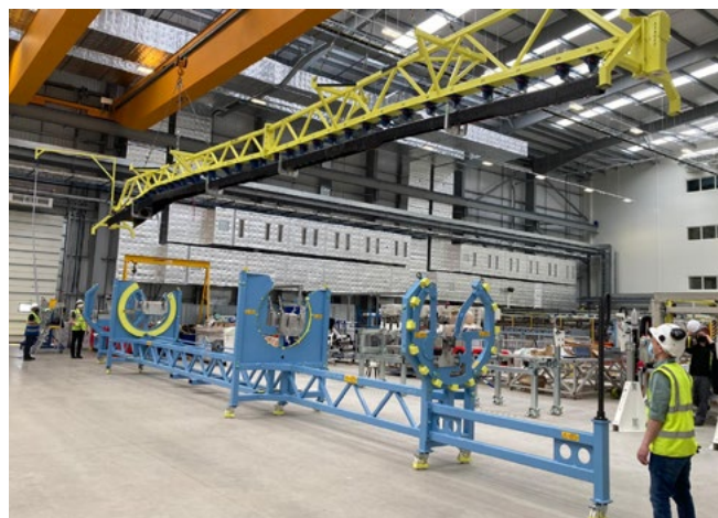
Фото 6. Готовый 17-метровый лонжерон поднимается из производственной оснастки Alrex (Источник: compositesworld.com)
