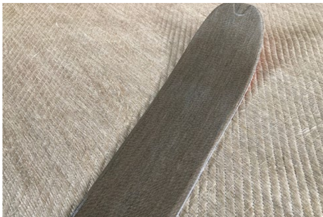
Фото 7. Компания Hexcel представила горные лыжи с использованием препрега из льняного волокна (Источник: jeccomposites.com)
