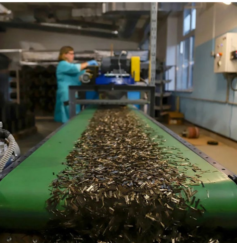
Фото 8. Производство базальтового волокна Магманит (Источник: vngru.ru)
