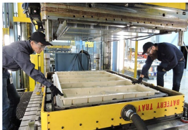
Фото 2. Специалисты компании Teijin Automotive Technologies извлекают большой аккумуляторный лоток SMC из оснастки компрессионного пресса (Источник: Teijin Automotive Technologies)
