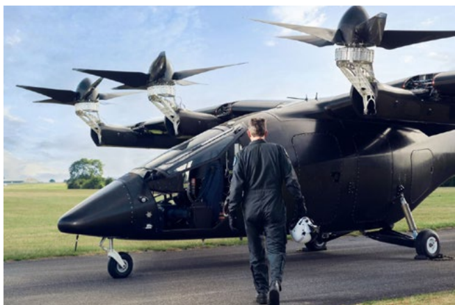
Фото 5. Пилотируемые испытания прототипа электрического конвертоплана (Источник: Vertical Aerospace)
