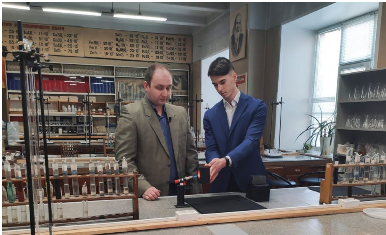
Демонстрация свойств тепло-огнезащитного углерод-углеродного композиционного материала в пламени горелки при 1200°C
