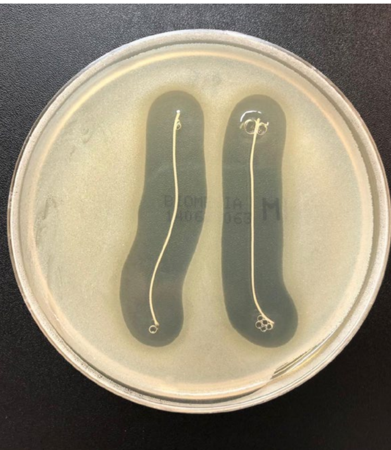
Антимикробные серебросодержащие нити. Серая область вокруг нитей — зона подавления роста клеток микроорганизмов
