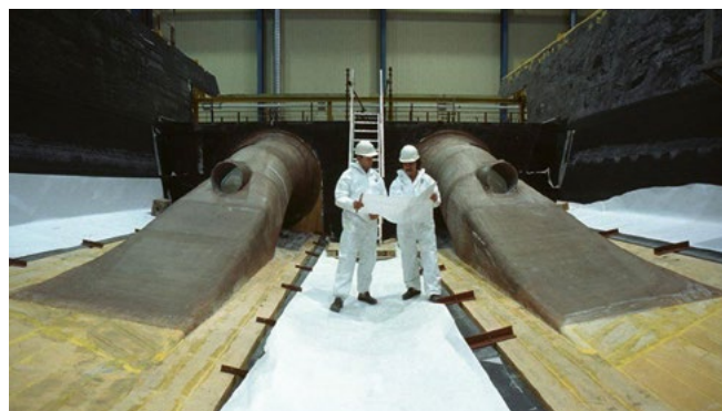
Рисунок 11. Водоводы водометов корвета класса Visby [5]
