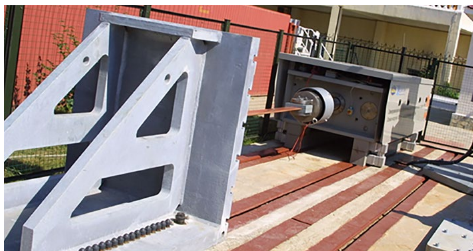
Рисунок 2. Горизонтальный стенд для испытаний крупногабаритных конструкций
