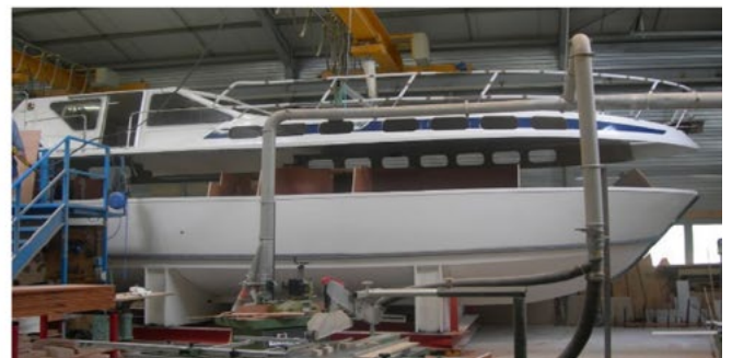
Рисунок 16. Основные конструктивно-технологические решения, применяемые при постройке прогулочных судов коммерческого назначения типа Тагроп. Формование корпуса и установка в него переборок и выгородок (слева сверху); Подготовка к установке секции палубы (справа сверху); Секция палубы после извлечения из оснастки (слева внизу); Установка секции палубы с насыщением на корпус (справа внизу).
