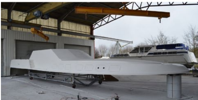
Рисунок 16. Основные конструктивно-технологические решения, применяемые при постройке прогулочных судов коммерческого назначения типа Тагроп. Формование корпуса и установка в него переборок и выгородок (слева сверху); Подготовка к установке секции палубы (справа сверху); Секция палубы после извлечения из оснастки (слева внизу); Установка секции палубы с насыщением на корпус (справа внизу).
