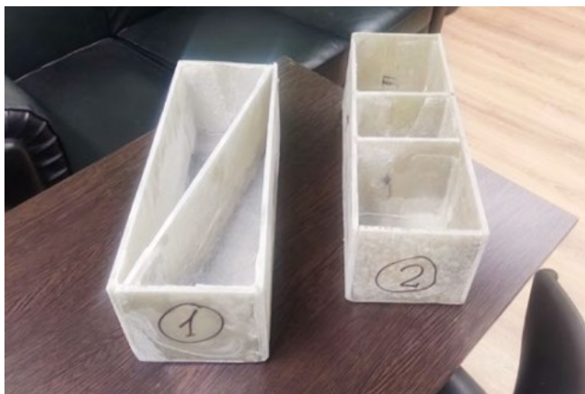
Фото 8. Модели опорных призм, подготовленные к испытаниям на прочность
