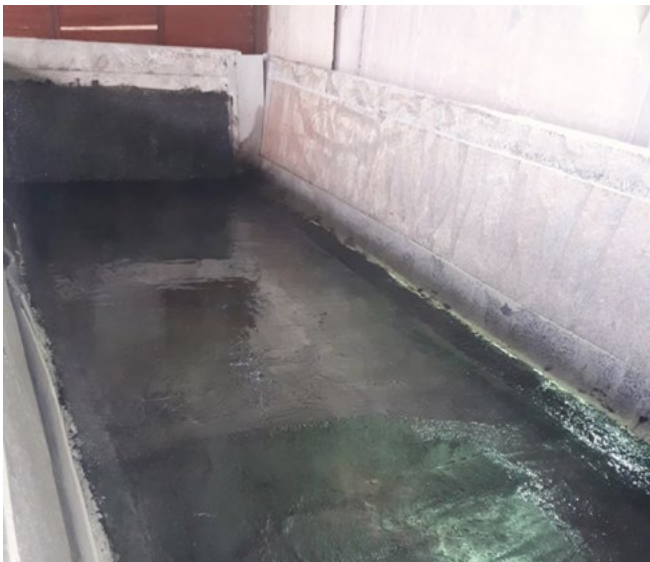
Фото 10. Думпкар с износостойким композитным покрытием дна
