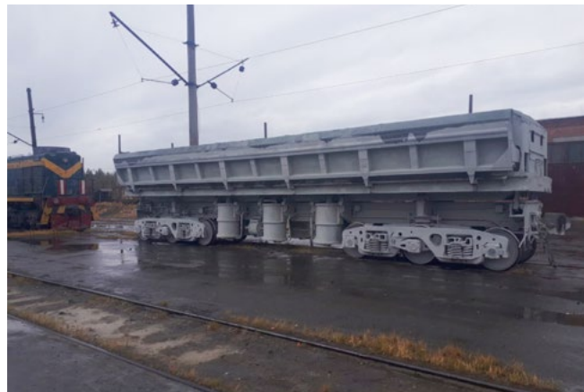
Фото 10. Думпкар с износостойким композитным покрытием дна
