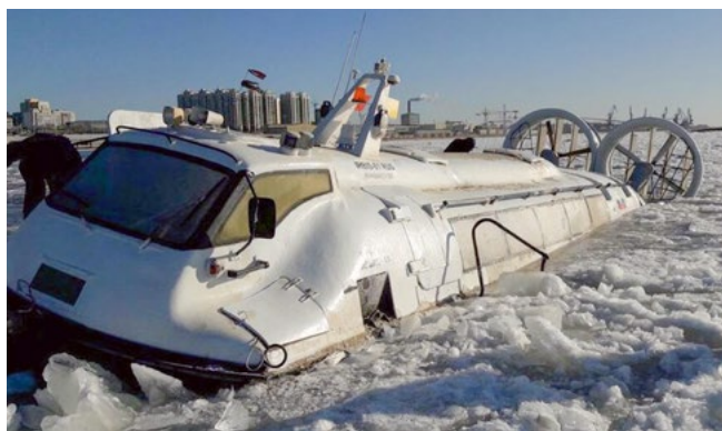
Рис. 5. Авария амфибийного судна на воздушной подушке проекта 15060 «Ирбис-1», имеющего в конструкции большое количество элементов из композитов, на Амуре
