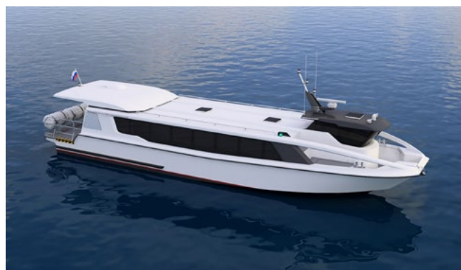
Рисунок 2. Проект пассажирского судна AMD1990 длиной 19,9 м из КМ
