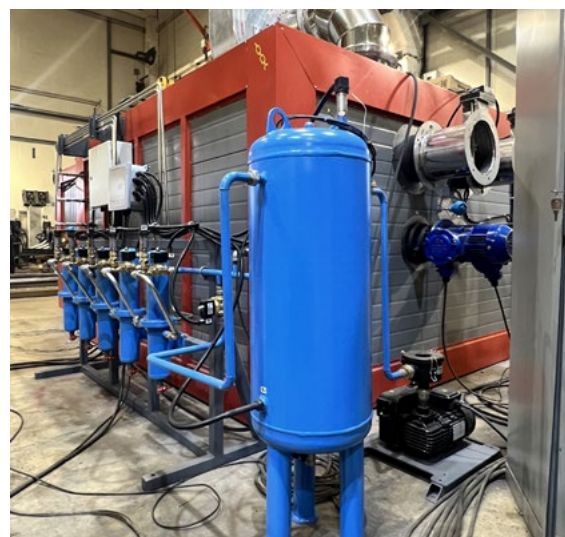
Рис. 2. Вид с разных сторон на печь с вакуумным блоком производства ЗАО «Вольна»
