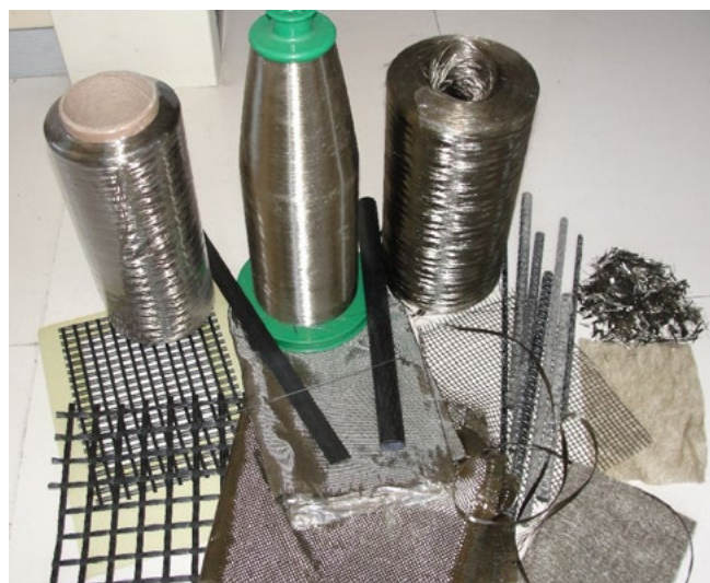
Рисунок 1. БНВ материалы: бухты ровингов, бобина нитей для производства тканей, рубленые волокна (фибра) для объемного армирования бетонов и асфальтобетонов, армирующие строительные и дорожные сетки, композитные профили, трубы, прутки и арматура, базальтовые ткани, нетканые материалы — холсты рубленых волокон, иглопробивные маты, базальтовая бумага, препреги
