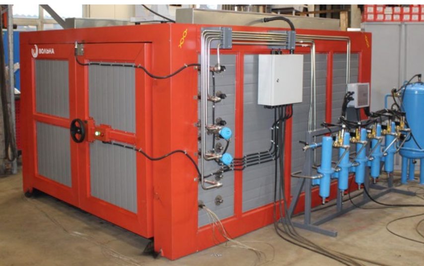
Рис. 2. Вид с разных сторон на печь с вакуумным блоком производства ЗАО «Вольна»
