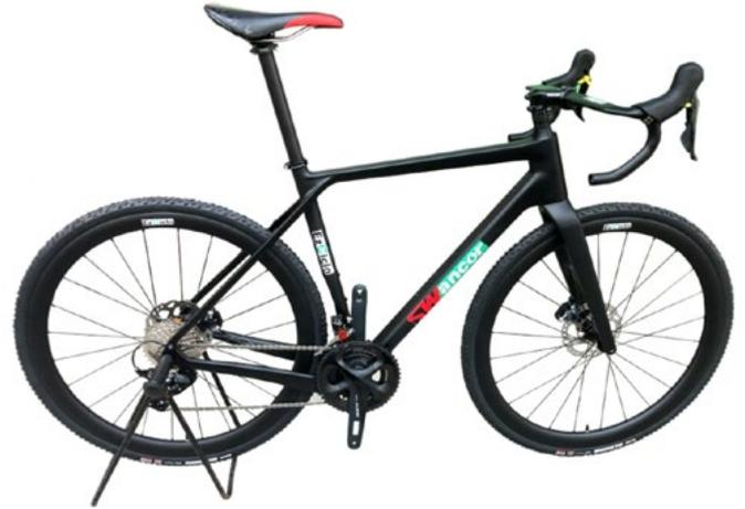
препрега EzCiclo. Композитные детали с истекшим сроком службы, изготовленные из EzCiclo, могут быть разрушены жидкостью CleaVER при температуре 130–150°C в течение 4 часов, что обеспечивает полное разделение матрицы и волокна. Сшитая матрица растворяется в CleaVER и может быть использована повторно. Вторичное волокно демонстрирует свойства, сравнимые с первичным волокном.
