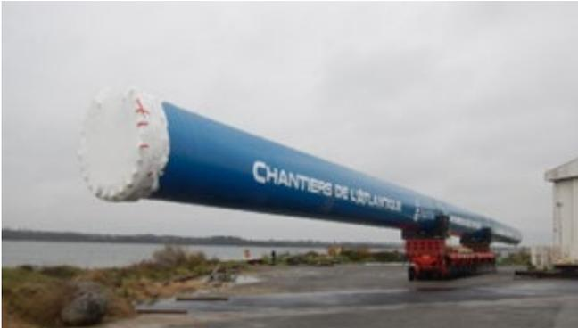
Для изготовления парусной мачты использовалась технология автоклавного формования углеродного препрега. Сначала изготавливались отдельные секции мачты, размер которых зависел от размера автоклава (24 м × 6 м). Затем следовал процесс сборки, с использованием специально разработанных соединительных рукавов, для быстрой и эффективной сборки секций длиной 24 м.
