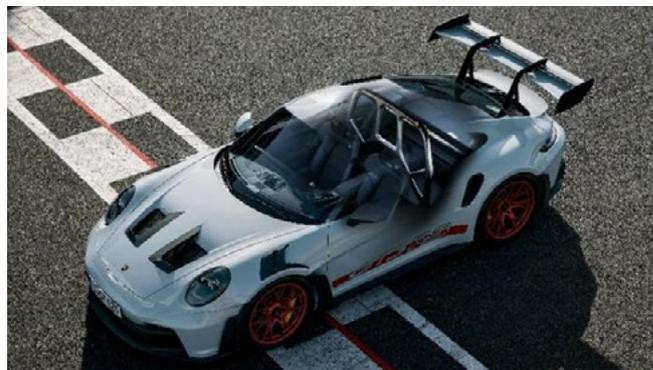
Чрезвычайно легкий каркас безопасности из углеродного волокна, который может быть установлен на серийные автомобили, благодаря уникальной геометрии. Ключевые преимущества разработки: значительное снижение веса по сравнению со сталью и титаном, оптимизированная геометрия и уникальный бионический дизайн, инновационный производственный процесс – серийное производство полых конструкционных детали.
