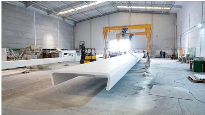
Элементы конструкции (балки) для крыши стадиона. Общая длина пролета 75 м. Производственный процесс представлял собой инновационную технологию вакуумной инфузии с двойной мембраной. Ключевые преимущества: снижение веса и простота установки на месте, отличные механические свойства, экологическая и энергетическая выгода.
