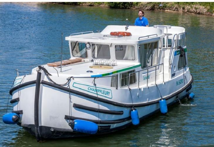
Рис. 1. Судно из композиционных материалов «Pénichette» 1020FB
