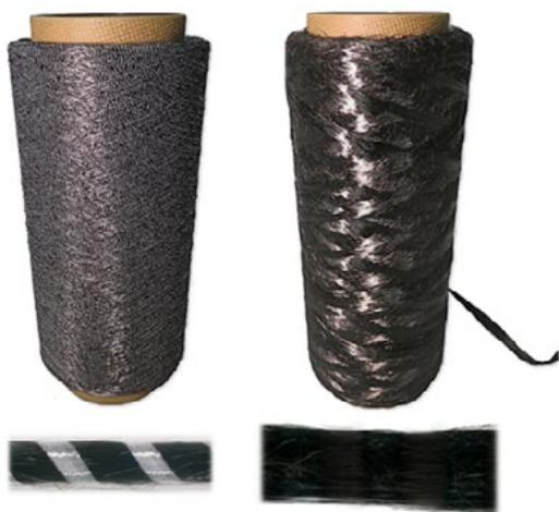
Компания внедрила комплексную систему рециклинга углеродного волокна от регенерации до воспроизводства. Свойства восстановленного углеродного волокна имеют предел прочности при растяжении около 70% и модуль упругости 90%, по сравнению с первичным углеродным волокном. Это первый в мире производитель, который успешно использует восстановленное углеродное волокно для пултрузионного формования с эпоксидной смолой.
