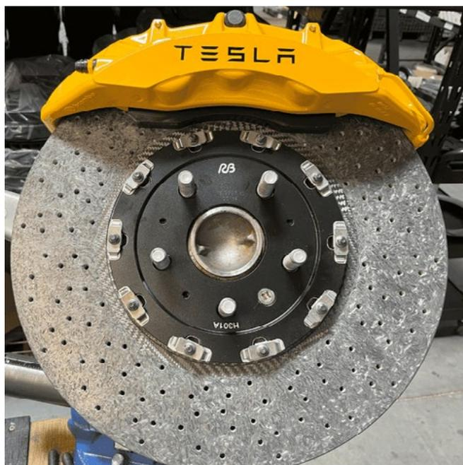
Рисунок 4. Углерод-керамические тормоза от компании Tesla.
